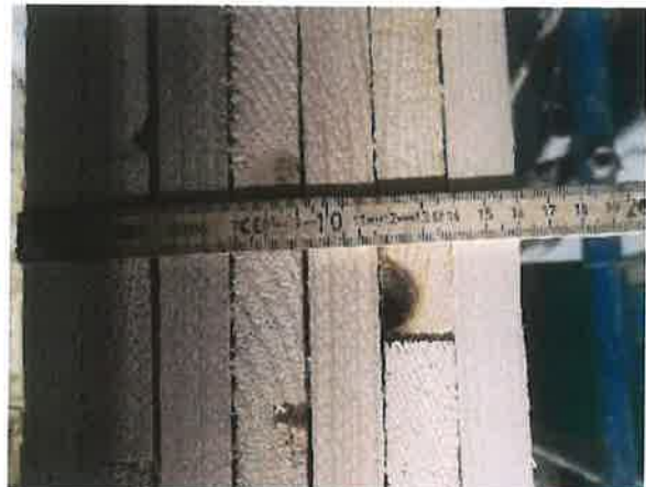
Bild 2: Blick auf den Querschnitt des Probekörpers bestehend aus 7 Lagen Nadelholz.
