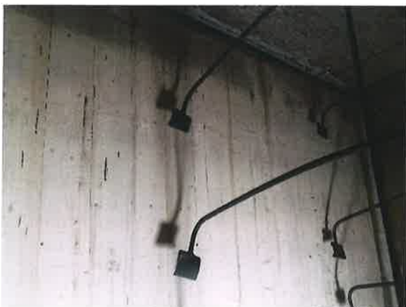
Bild 5: Blick auf die feuerzugewandte Wandseite B vor dem Start der Feuerwiderstandsprüfung.
