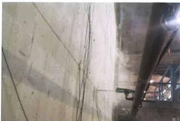
Bild 9: Prüfminute 7 – Mäßiger Rauchaustritt aus Vertikalfuge des Probekörpers.
