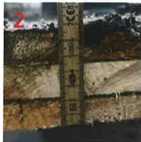
Bild 16: Restquerschnitt 2 (ca. 65 mm)
