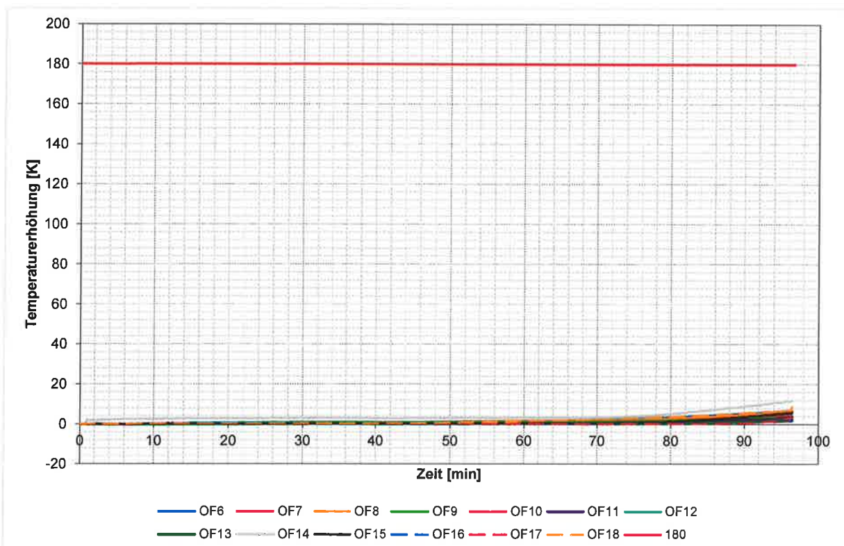
Diagramm 11 Temperaturentwicklung auf der Oberfläche der Wandkonstruktion zur Bestimmung des Maximalwertes (OF6 – OF18)
