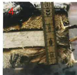
Bild 18: Restquerschnitt 4 (ca. 75 mm)
