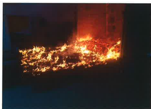
Bild 12: Ende der Feuerwiderstandsprüfung infolge Tragfähigkeitsversagen der Prüfkonstruktion.
