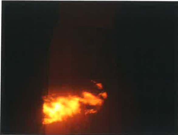
Bild 7: Prüfminute 1 – Schwarzfärbung der Probekörperoberfläche.
