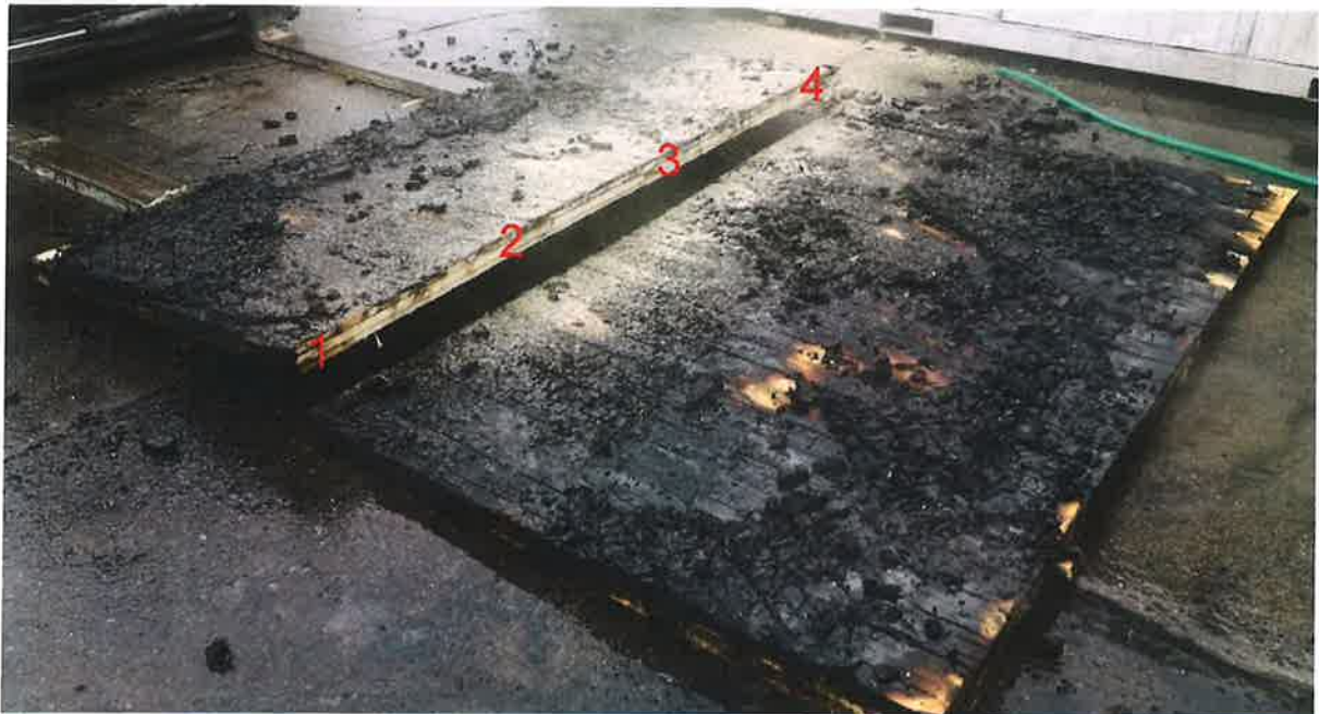
Bild 14: Blick auf den abgelöschten Probekörper. Zur Dokumentation des Restquerschnittes wurde der Probekörper ca. 1500 mm vom oberen Rand aufgetrennt.
